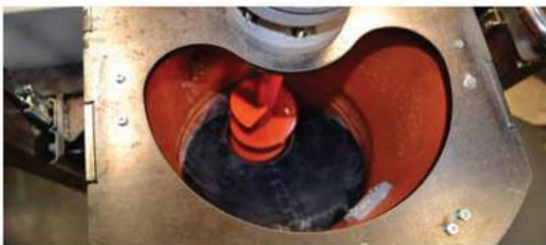
Zásobník tiskové hlavy s podávacím šnekem
